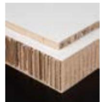
Núcleo de celdas hexagonales que le hace muy resistente y ligero. Fácil de cortar con cúter o caladora, pueden recubrirse prácticamente con cualquier material. De fácil mecanización, admiten cortarse con máquinas de control numérico y crear formas complicadas. Además, pueden imprimirse, pintarse y encolarse.
